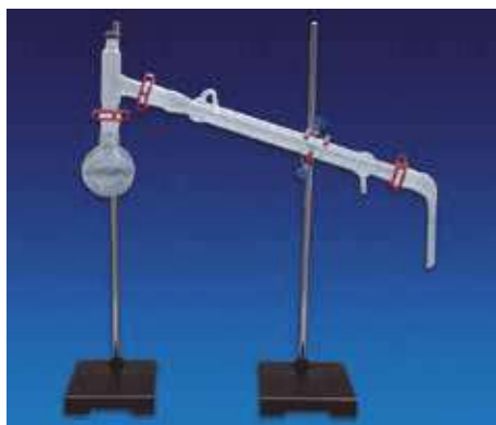
1 | Fabricado en vidrio borosilicato con uniones esmeriladas 29/32.
