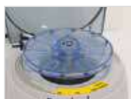
Cabezal microhematocrito para 12 tubos
